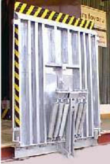
Wir sind Produzenten von schwenkbaren und stationären Überladebrücken. Schwenkbare Überladebrücke wird an der Rampenvorderkante montiert, zum Ladevorgang wird die Überladebrücke mit einer Bedienungsstange auf die Ladefläche heruntergelassen. Die Ladebrücke besteht aus einer soliden Stahlkonstruktion, Höchstbelastung ist 60kN. Unter der Tragfläche ist ein kräftiges Federpaket, das als Gewichtsausgleich dient. Damit ist die Bedienung per Hand mit minimaler Kraftanstrengung möglich.
